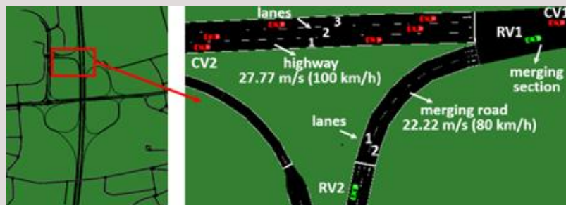
Abb. 2: Straßennetz und Verkehr für ein Autobahnszenario in SUMO für kooperative Merging- und Fahrspurwechselmanöver.
